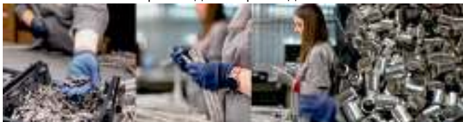
На отрезки рукава надеваются фитинги и обжимные гильзы. Происходит сборка изделия.
